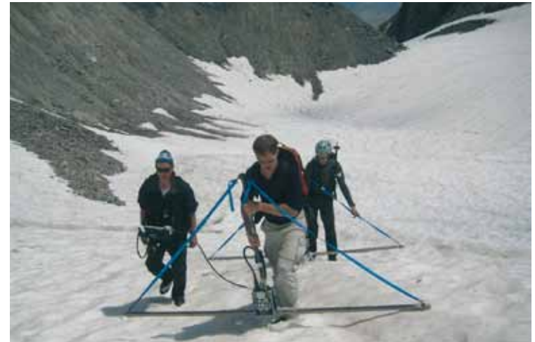
Dickenmessung auf dem Eiskargletscher am 1. Juli 2010
